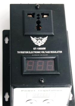
Регулятор мощности с показанием напряжения. Упрощает работу управления тэном. Рекомендуемая максимальная нагрузка до 5 кВт. Рабочий режим регулятора мощности от 10 до 220 вольт.
