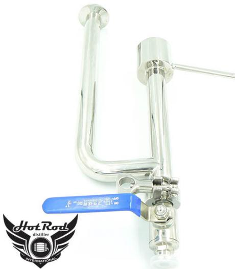
Высококачественный переливной сборщик продукта (также известный как попугай или спиртовой фонарь) изготовлен из нержавеющей стали. Эта важная часть установки легко монтируется с помощью клампов и позволяет контролировать крепость продукта в разрыв струи. Форма и угол выхода продукта обеспечивают чистоту жидкости непосредственно в емкость для сбора. Подходит для стандартных ареометров серии АСП-3. Выпускной шаровый кран предназначен для байпаса при отделении голов и хвостов.
