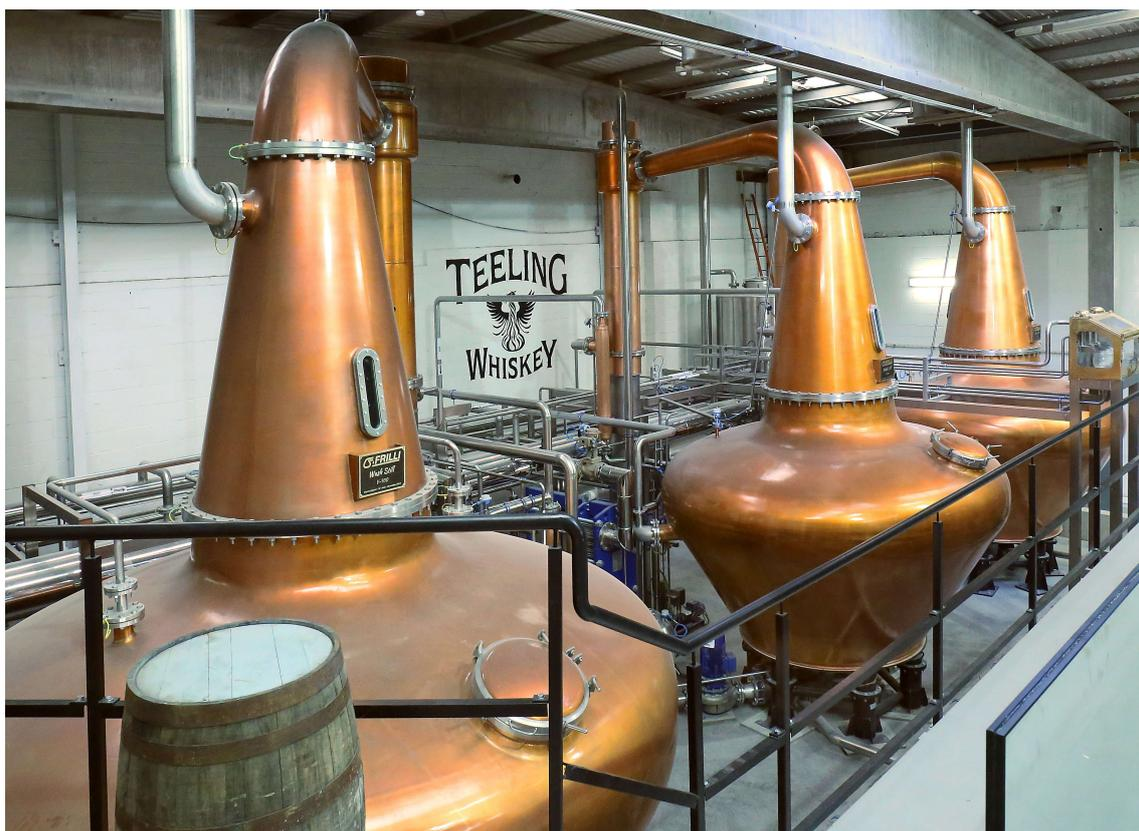
*Виски в Северной Америке дистиллируется двумя способами. Один из них — это метод непрерывной бражной колонны, а другой — прерывающийся процесс порционных кубов.*
